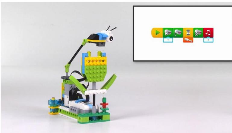
В этой модели проекта используются шестерни. Эти шестерни движутся по оси, к которой прикреплена пчела. Цветок использует датчик перемещения, чтобы определить, когда пчела находится над ним.
