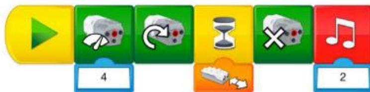
Эта программа будет поворачивать двигатель в одном направлении до тех пор, пока не обнаружит пчелу над цветком. Когда это происходит, двигатель останавливается, и воспроизводится жужжание пчелы.
