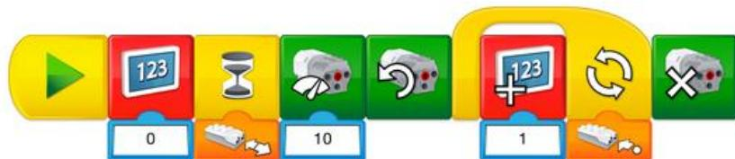
Воспитанникам необходимо держать руку перед гоночным автомобилем до запуска программы. Программа начинается с отображения знака «0» и ожидания стартового сигнала. Когда дети уберут руки программа запустит двигатель, разгонит до максимальной мощности, затем повторит цикл, добавив «1» на экране. Цикл будет повторяться до окончания гонки. Затем двигатель будет отключен.
