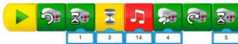
Эта программа будет вращать двигатель в одном направлении в течение 1 секунды, чтобы кузов перешёл в положение для сброса. Затем программа ожидает 3 секунды, пока учащийся загружает коробки, подается звуковой сигнал, а затем кузов переворачивается для сброса коробок.
