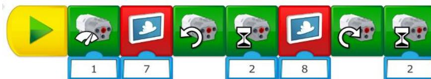
Эта программа будет показывать изображение осадков и вращать двигатель в одном направлении в течение 2 секунд. Затем будет показано изображение солнца, и двигатель будет вращаться в течение 2 секунд в другом направлении.
